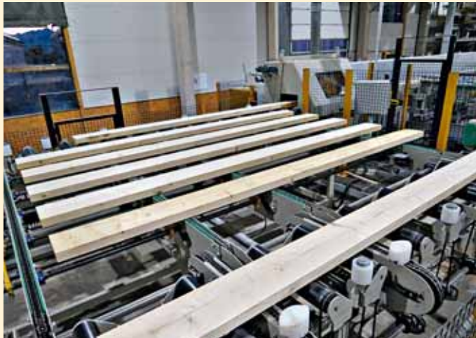
Puffer vor der Fehlstellenkappsäge, im Hintergrund rechts die Fehlstellenkappsäge „KK700“ von HIT.
