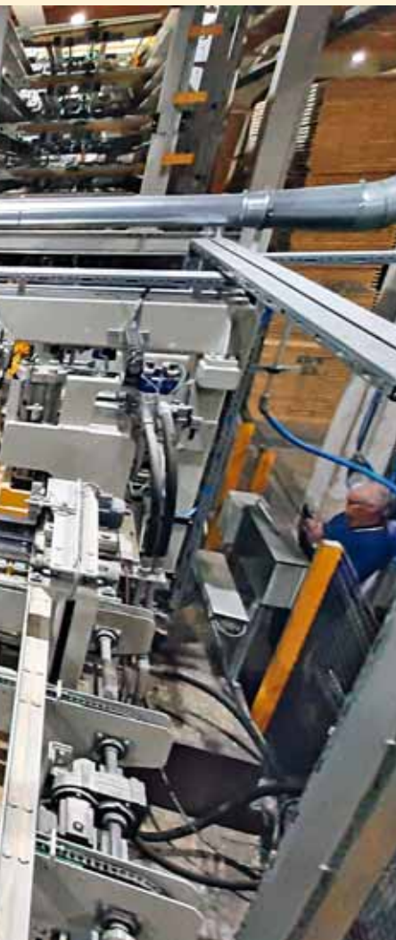
Übergabe der Hölzer von der Fehlstellenkappsäge (hinten rechts) über eine Winkelübergabe (rechts) an die erste Fräseinheit.
