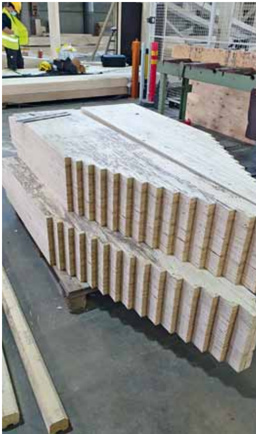
„Anschlussknoten“ von Ober- und Untergurt mit Treppenversatz, Schrauben und unterseitigem Auflagerklotz. (Fotos: Introgroup)
