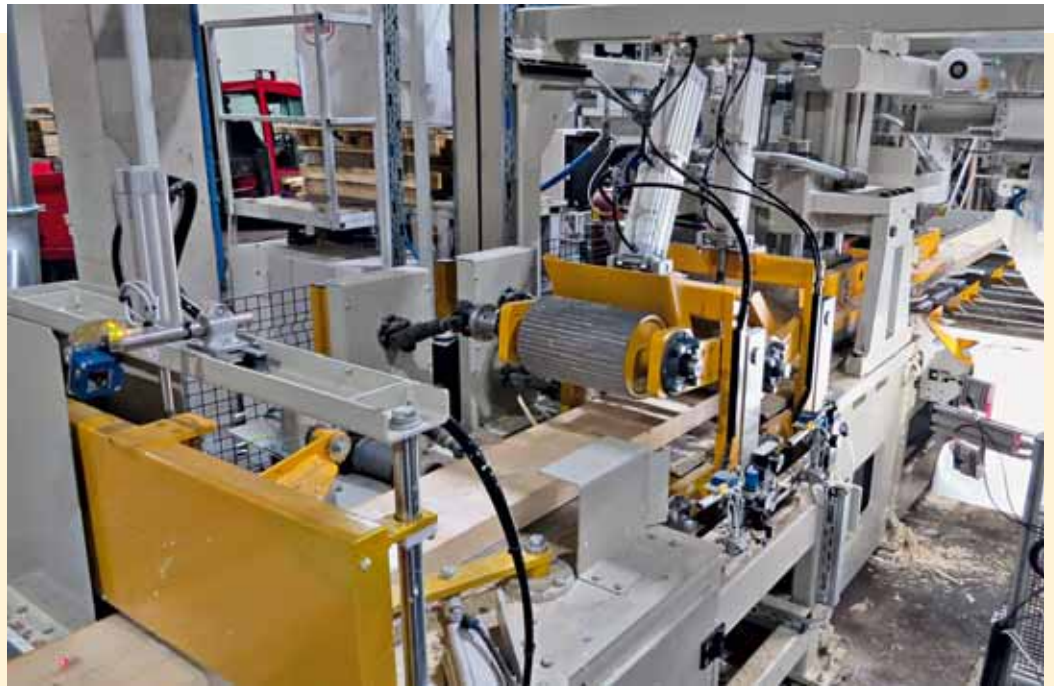
Auszugeinheit hinter der Keilzinkenpresse. Im Vordergrund die Abdeckhaube der Ablängsäge, die die Soll-Längen nach der Zinkung auskappt. (Fotos HIT)
