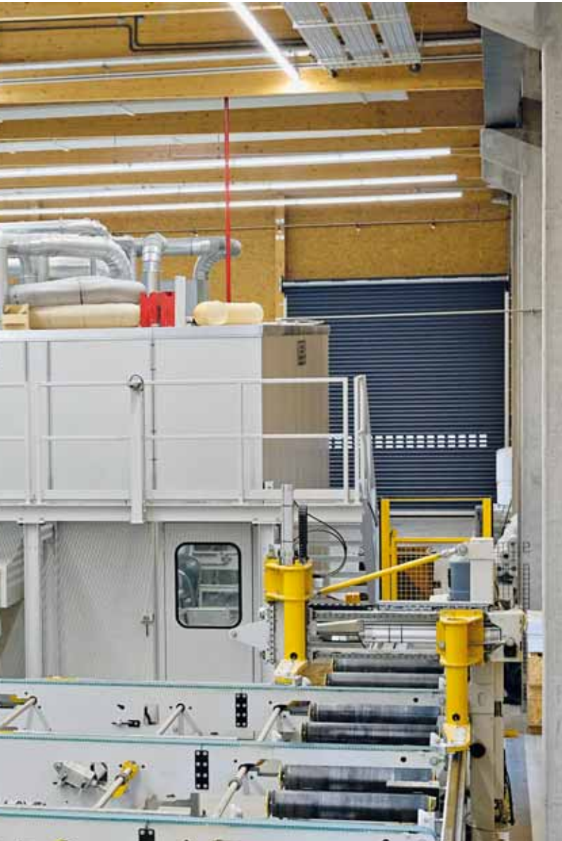
Wechselwellen der Hobelanlage, bestückt mit „Vario 100“-Werkzeugsätzen. Bis zu 300 mm Blockhöhe können bearbeitet werden.
